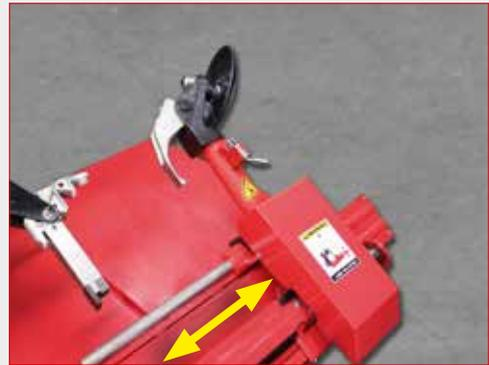
*O empilhador de ferramentas é **semi-automático**. O levantamento do braço é **hidráulico**, permitindo trabalhar com velocidade e sem fadiga. A rotação das ferramentas é ativada graças à cômoda e rápida alavanca de liberação. O valor acrescentado deste trocador de pneus é, com certeza, o **movimento rápido** do braços de ferramentas. Isto permite mover-se rapidamente graças aos **710 mm de movimento** que o carrinho de ferramentas oferece.*
