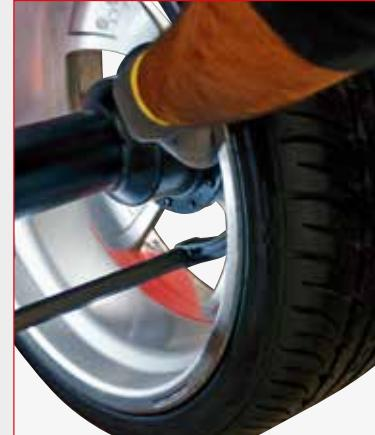
**Novo calibre digital** para a aquisição do diâmetro e da distância com função **FSP (Fast Selection Program)** e **novo ponteiro LaserBlade integrados**: a função FSP ativa automaticamente os programas de balanceamento, evitando assim as seleções a partir do teclado, enquanto o ponteiro LaserBlade (no interior do braço de medição) guia o operador na seleção dos planos internos da jante de liga sem erros e com visibilidade extrema.
