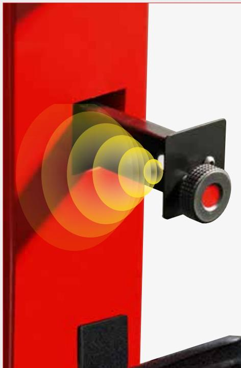
**Sistema de diagnóstico da excentricidade radial da roda** devido a vibrações que não podem ser resolvidas com o simples balanceamento. A presença do sensor sonar run-out ativa automaticamente a nova função de software **BESTFIT** que indica no vídeo o ponto de maior excentricidade da roda e sugere como montá-la no cubo do veículo, antes do aperto dos parafusos, de modo a cancelar as vibrações diretamente na fase montagem no veículo.
